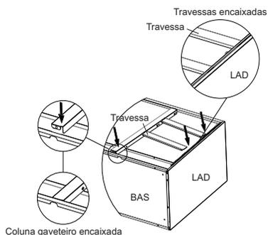
6.1 Encaixe as travessas já montadas com a coluna gaveteiro, na lateral direita (LAD) e a coluna gaveteiro na base (BAS).
