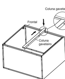
5.1 Encaixe a coluna gaveteiro no frontal, deixando-a levemente inclinada.
