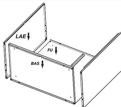
4º Encaixe o Frontal nas laterais para fechar o corpo, fixe com parafuso M4x6mm e porca M4.
