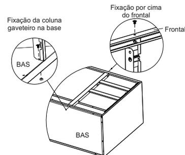
6.2 Fixe os parafusos M4x6 com as porcas M4 nas extremidades da coluna gaveteiro.
